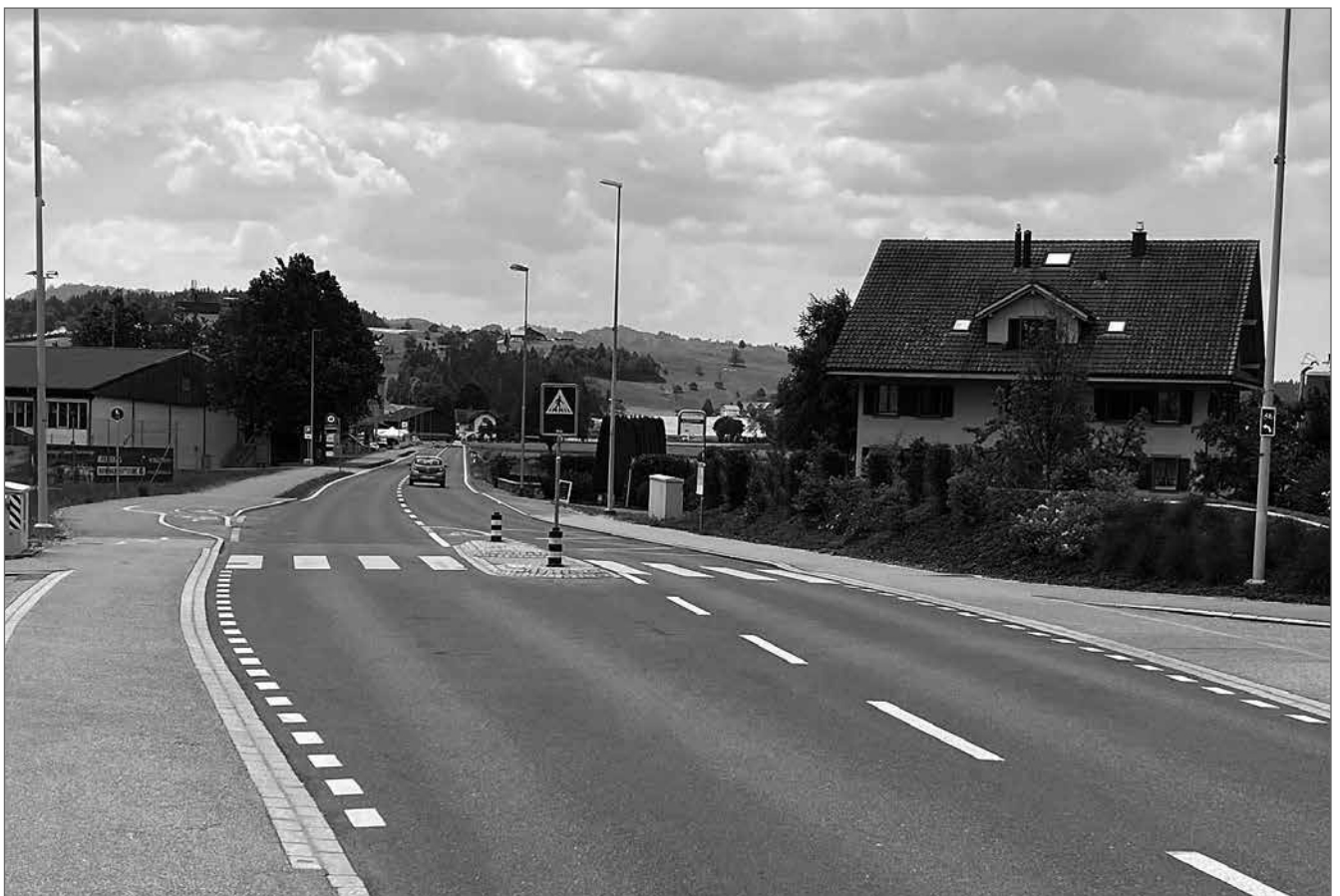
Beginn / Ende des Rad- und Gehweges (libks) an übersichtlicher Stelle mit Querungshilfe aber etwas minimalistisch. Die Signalisation ist eher sparsam.
